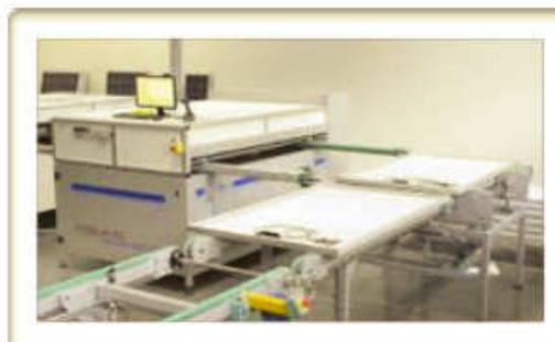
Verifica funzionamento moduli fotovoltaici
