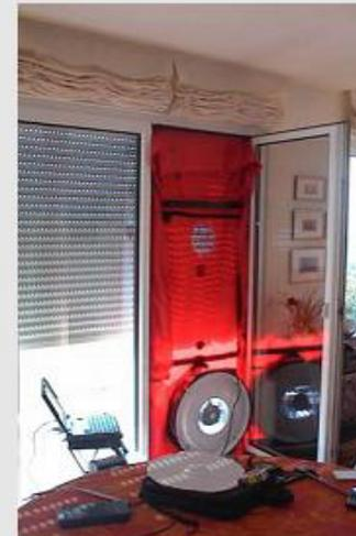
Perdite energetiche per ventilazione – Requisiti prestazionali e test di tenuta al vento
