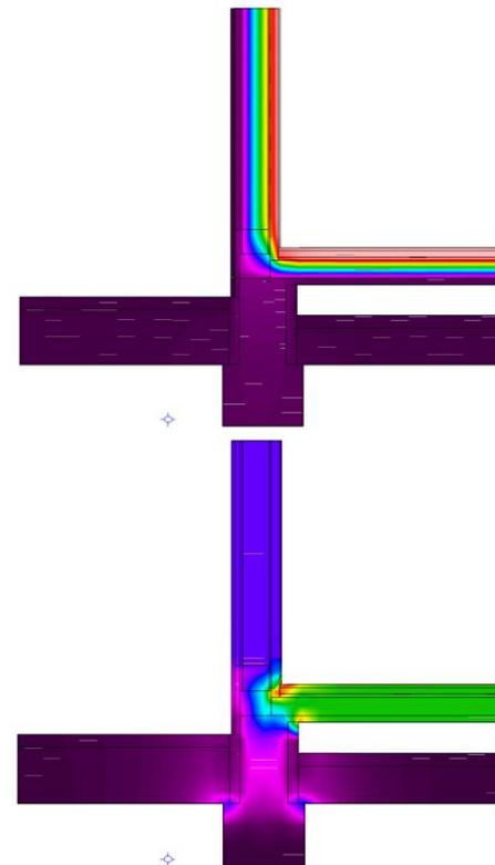
Diagramma flussi di calore
