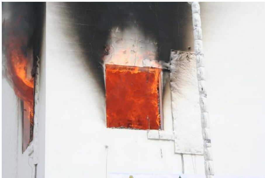
Resistenza strutturale al fuoco Sistema CLT
