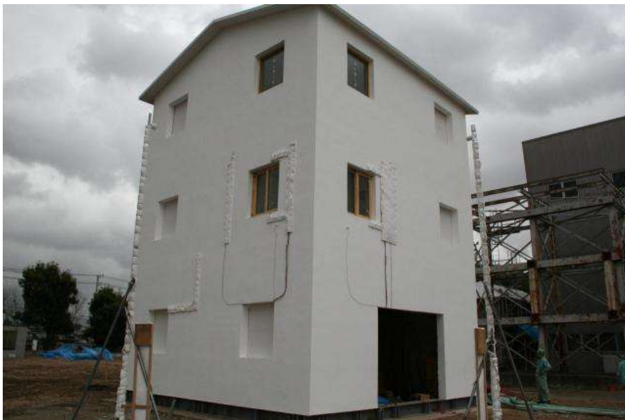
Resistenza strutturale al fuoco Sistema CLT
