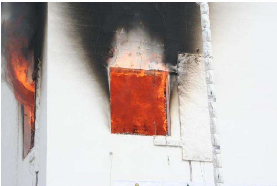
Resistenza strutturale al fuoco Sistema CLT
