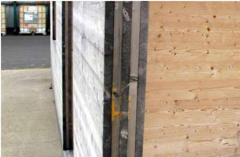
Resistenza alle intemperie Sistema CLT
