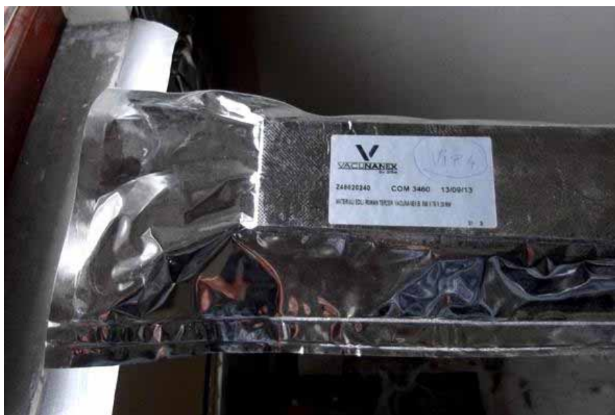
Pannelli sottovuoto “VIP” da 2 cm di spessore
