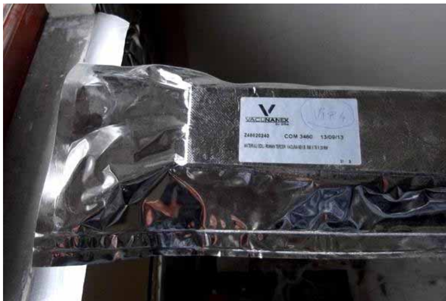
Pannelli sottovuoto “VIP” da 2 cm di spessore
