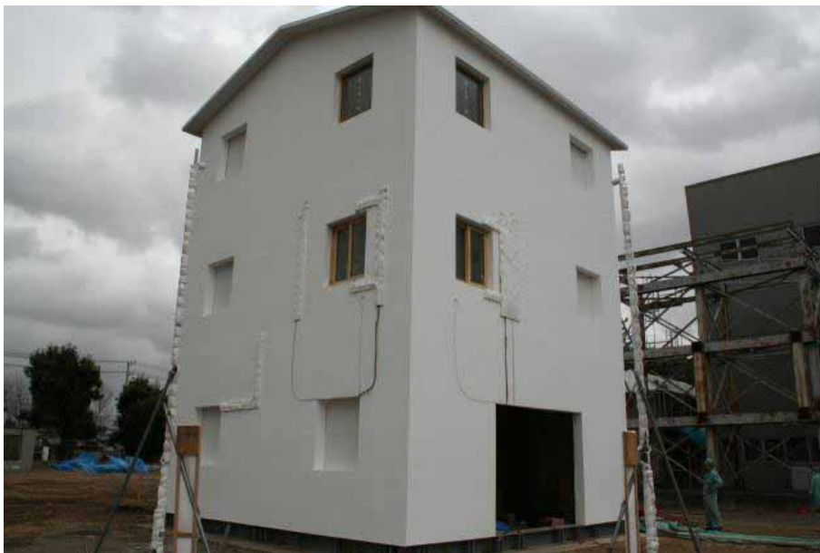
Resistenza strutturale al fuoco Sistema CLT
